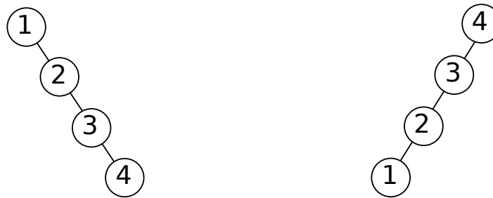
(a) Arbre résultant de l'insertion de 1, 2, 3 et 4 (b) Arbre résultant de l'insertion de 4, 3, 2, 1
